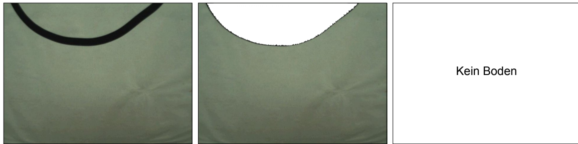
Abbildung 5.3: Vergleich der Bodensegmentierung in einer Beispielszene. Originalansicht (links), Segmentierung mit Region-Growing und individuellem Startpunkt (Mitte) und Region-Growing mit Startpunkten aus der 3D-Klassifizierung.
