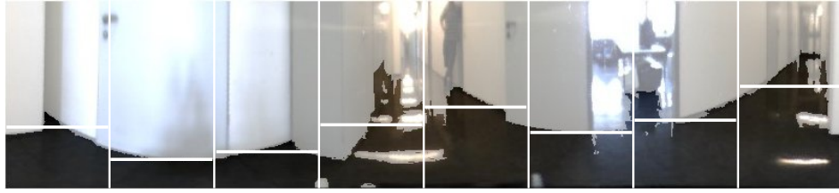
Abbildung 4.3: Bodensegmentierung in der omnidirektionalen Ansicht. Aus der Segmentierung kann die Verteilung des Bodens entsprechend der Merkmale ermittelt werden.
