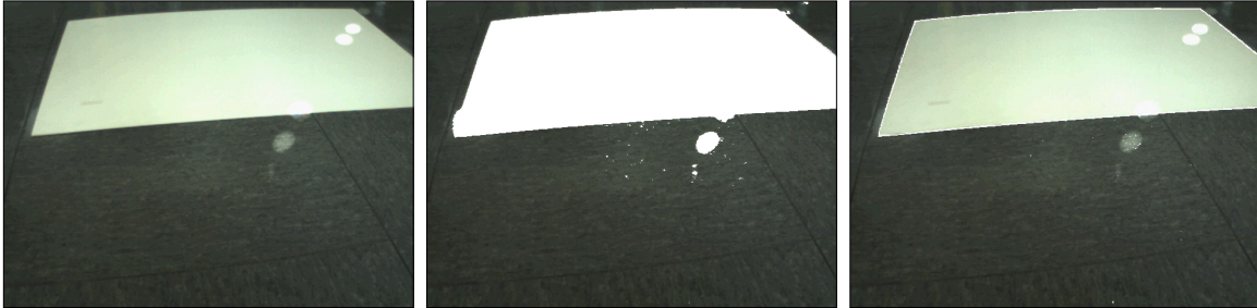
Abbildung 5.4: Vergleich der Bodensegmentierung in einer Beispielszene. Originalansicht (links), Segmentierung mit Region-Growing und einzelнем Startpunkt (Mitte) und Region-Growing mit Startpunkten aus der 3D-Klassifizierung.
