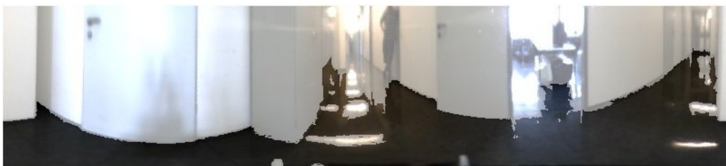
Abbildung 3.8: Segmentierte omnidirektionale Ansicht der lokalen Umgebung. Das Bodensegment ist optisch hervorgehoben und dient als Grundlage zum Beispiel für die Korridorfolge.
