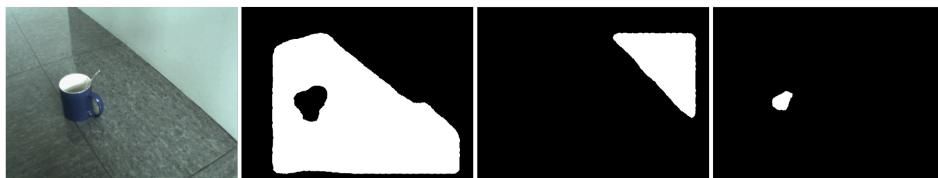
Abbildung 3.5: Watershed-Marker einer Beispielansicht. Von links nach rechts: Monokulare Ansicht, Boden-Marker, Wand-Marker und Hindernis-Marker.
